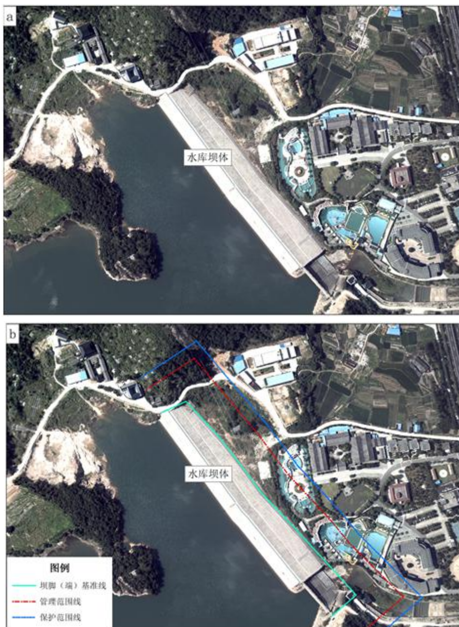
图 5-6 水库坝体以坝两端和大坝背水坡脚划定基准线
